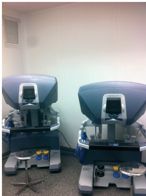
Figura 2. Robot «maestro» constituido por dos consolas, en una de las cuales se sienta el cirujano para operar.
