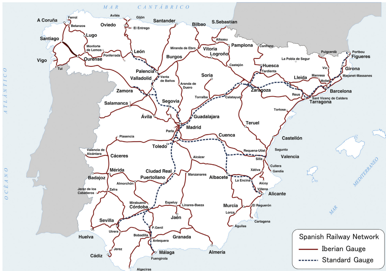
Fig. 1. The Spanish railway network (2017). Courtesy of the Fundación de los Ferrocarriles Españoles.
